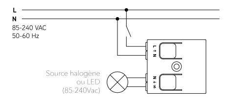
**Remarque :** Le CBU-TED permet la gradation de sources halogène par exempe. Il est également possible de graduer des ampoules LED (GU10 / E27) mais il est fortement conseillé de faire un essais avant de faire une installation.
